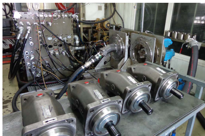
Stanowisko do testowania pomp i silników po naprawie
