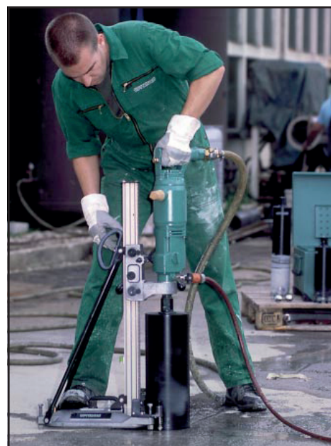
Wiertarka rdzeniowa pneumatyczna Spitznas nr kat. 2 1336 0010 Wersja przeciwwybuchowa IM2ExhIMbT6
