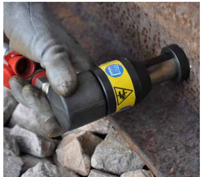
Głowica RHTEP w trakcie przeciągania łącznika AR60D
