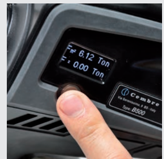
Wielofunkcyjny wyświetlacz OLED z przyciskiem dotykowym
